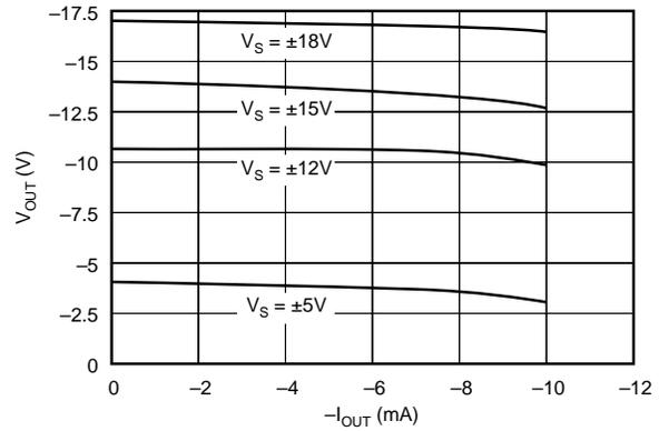
MAXIMUM  $V_{\text{OUT}}$  vs  $I_{\text{OUT}}$
