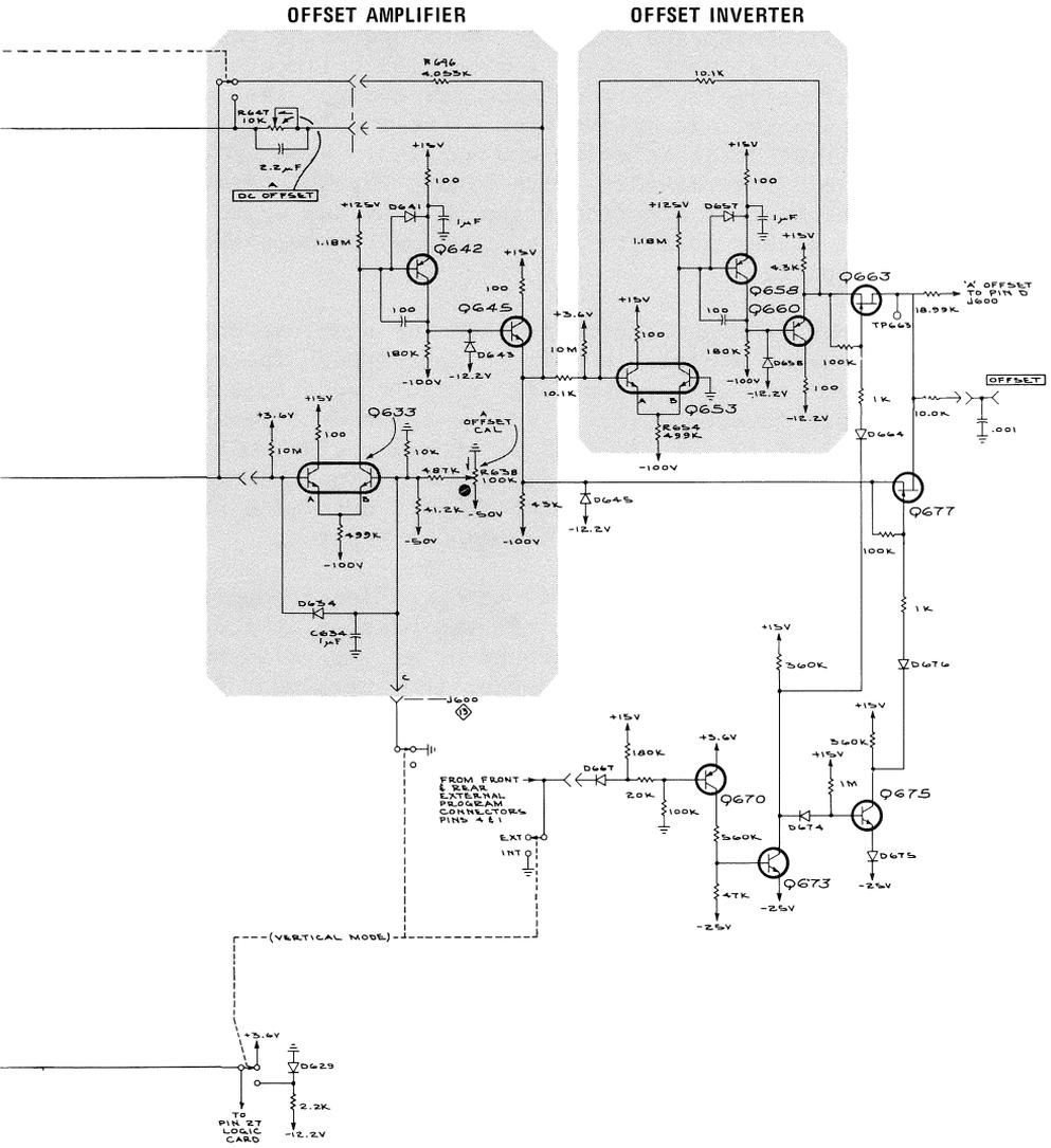
Fig. 3-8. 3S5 Ch A Programmed Offset.
