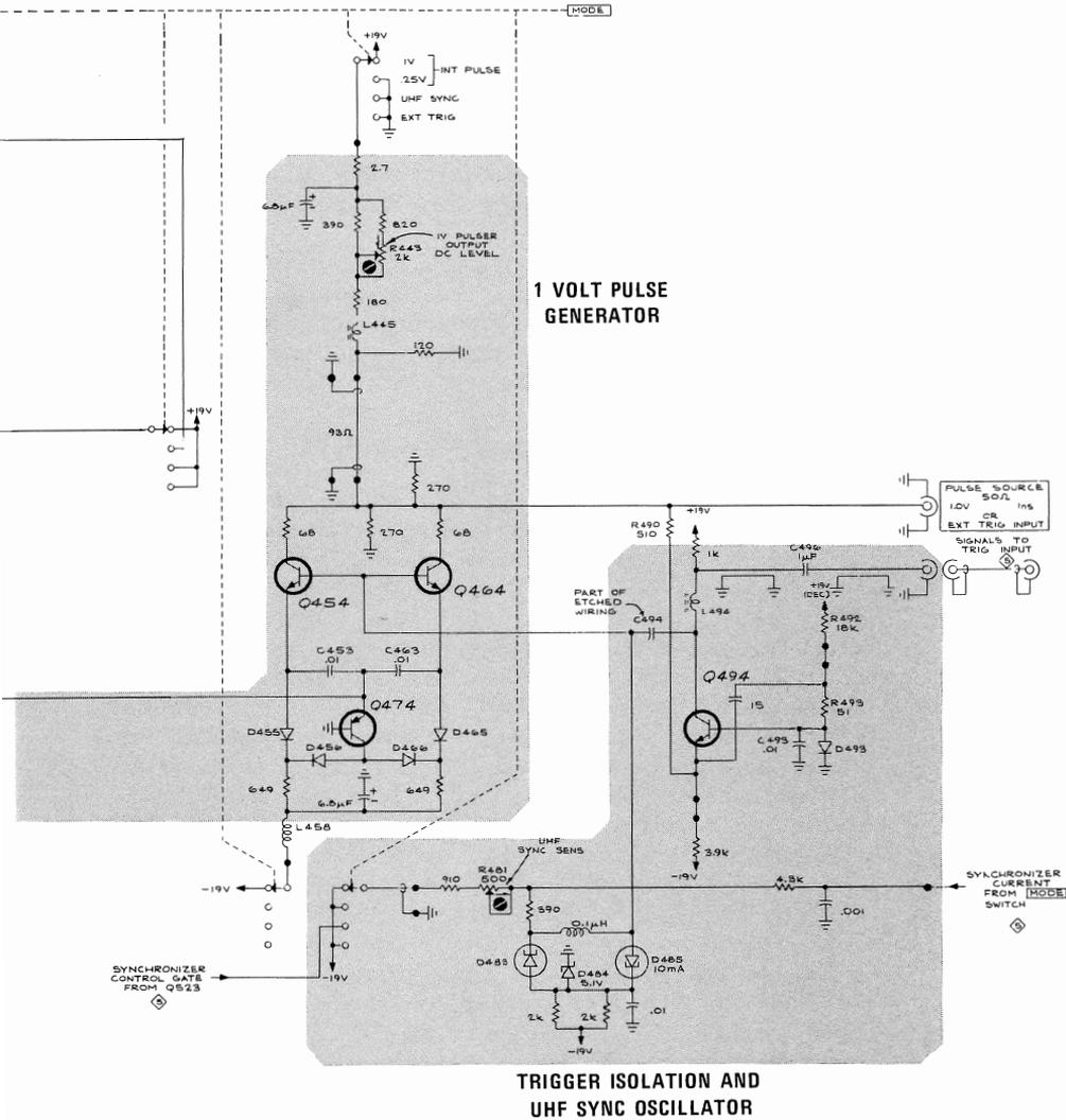
Fig. 4-2. 1S2 Pulse Generators.
