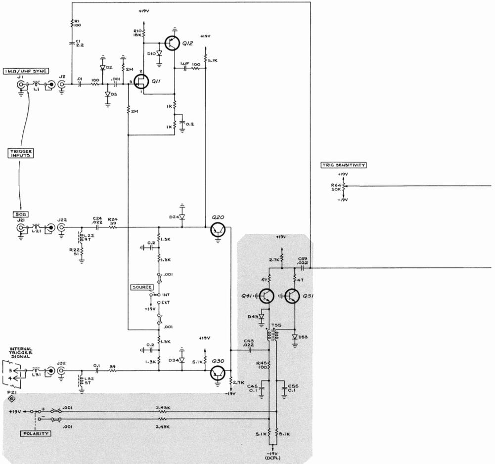
±SLOPE SELECTOR AND TRIGGER ISOLATOR
