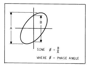
Fig. 36. Phase shift calculation.
