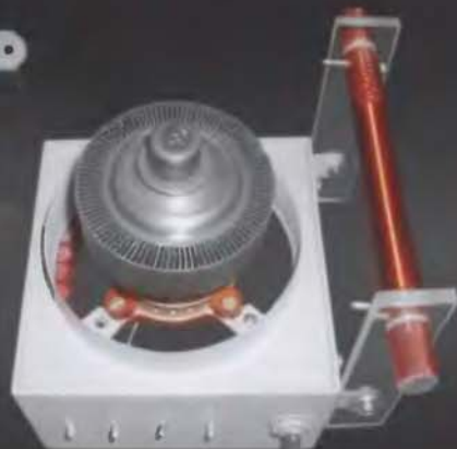
Крепление анодного дросселя к модулю усилителя.
