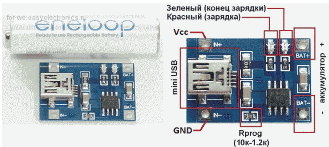
Схема практически идентична схеме из даташита, за исключением подключения термодатчика аккумулятора. На полученных модулях цвет светодиодов окончания зарядки другой, вместо зеленого — синий.
