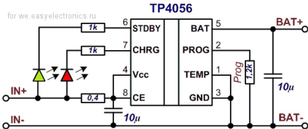
Можно (если понадобилось) вывести вход термодатчика отдельным проводком, напаявшись на лапку и отрезав ее от GND. Или же подняв лапку над платой и напаявшись. Если же хочется без паяния, надо просто заказать там же другой модуль:
