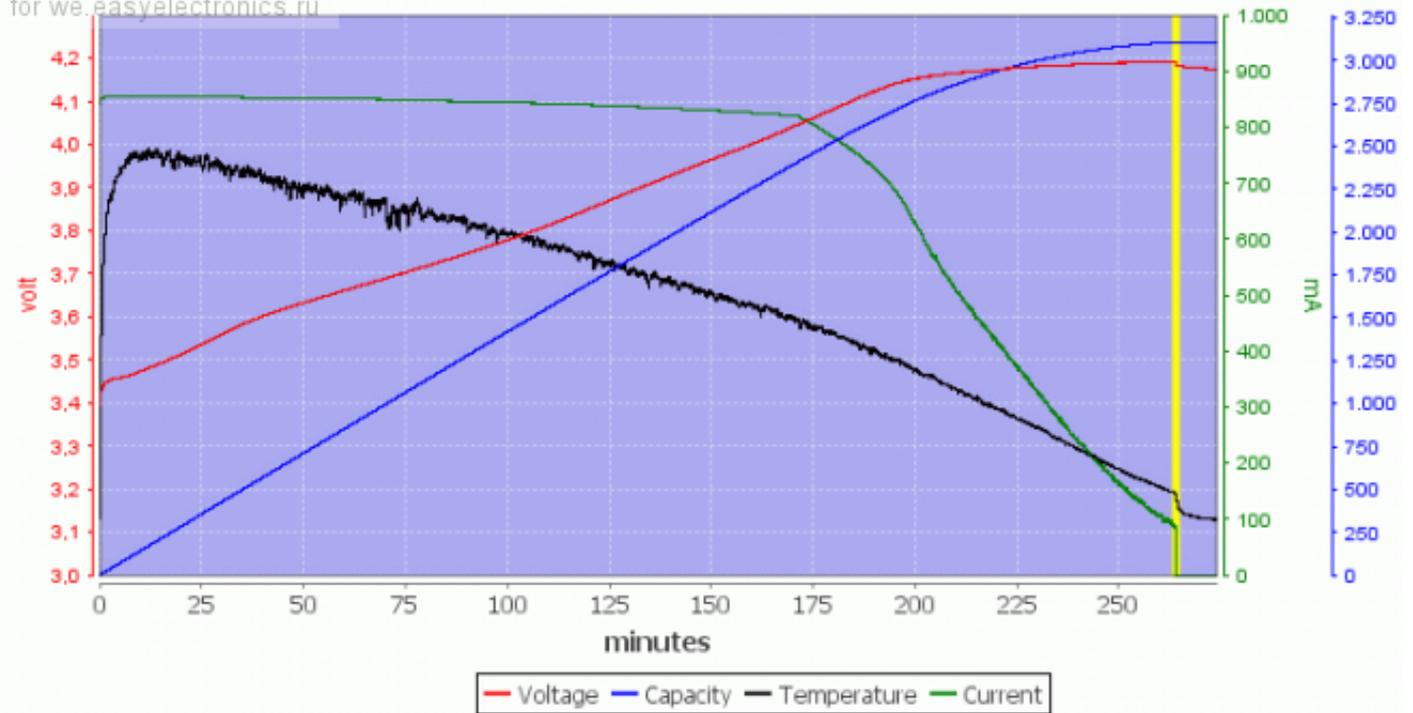
Очень хороший график CC/CV, немного затянуто падение CC, это увеличивает время зарядки, но аккумулятору от этого хуже не будет. Ток зарядки не достиг заявленных 1000mA. Возможно его ограничила температура самого контроллера. Контроллер сначала сильно разогревшись к концу зарядки остывает.
