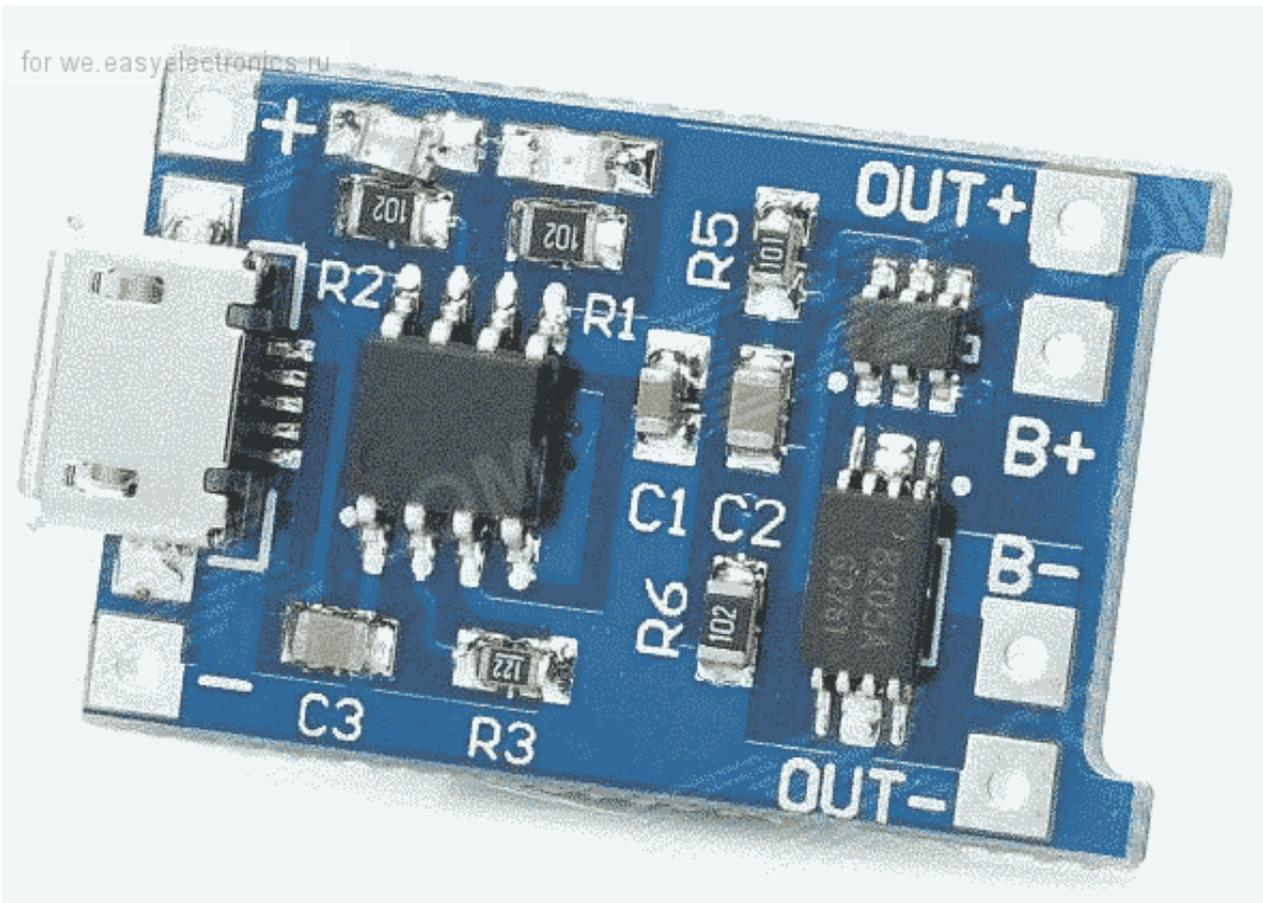
Кроме контроллера зарядки TP4056 в него добавлены два чипа: [DW01](#) (схема защиты) + [ML8205A](#) (сдвоенный ключ MOSFET).
