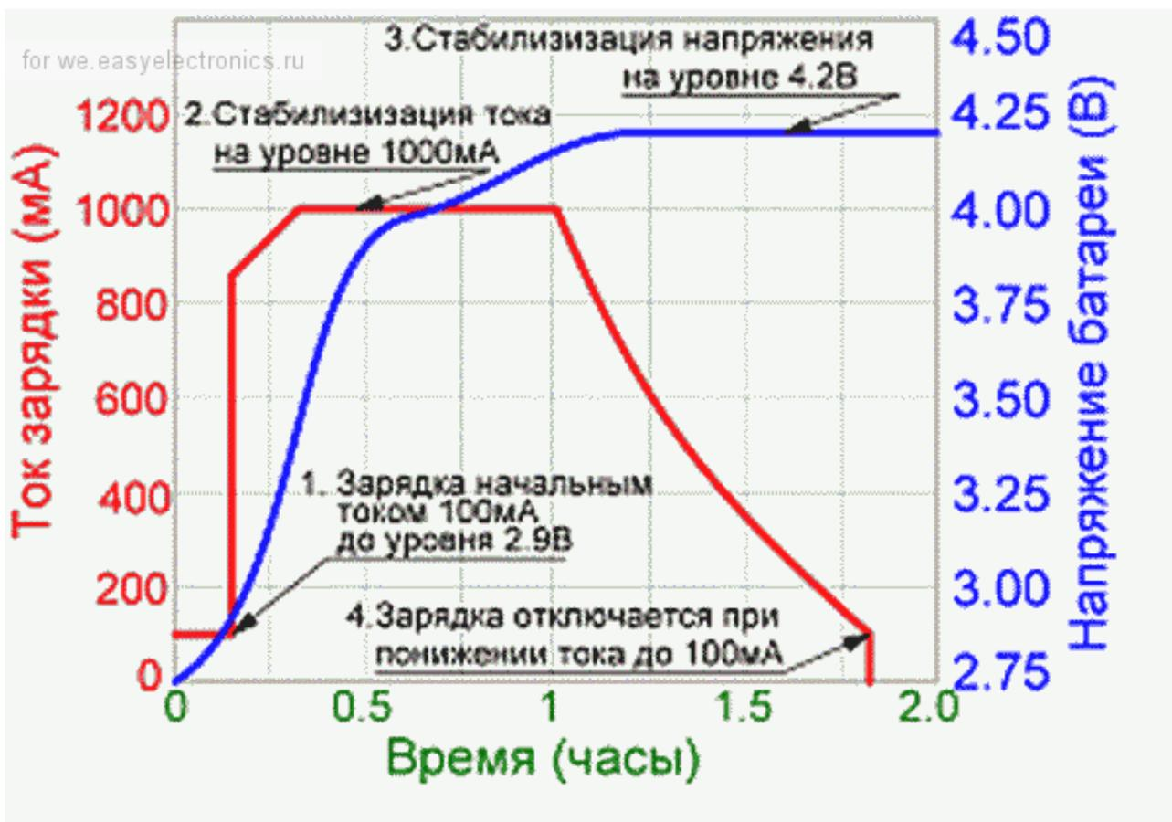
Контроллер имеет хороший профиль CC/CV и может быть адаптирован ко многим различным конфигурациям зарядки и типам Li-ion аккумуляторов. Номинальный зарядный ток может быть изменен подбором единственного резистора.
